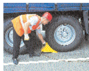
Unterlegkeile hindern das Fahrzeug zuverlässig am Wegrollen
