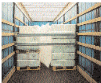
Die Ladung liegt „formschlüssig“ allseitig an den Laderaumbegrenzungen an
