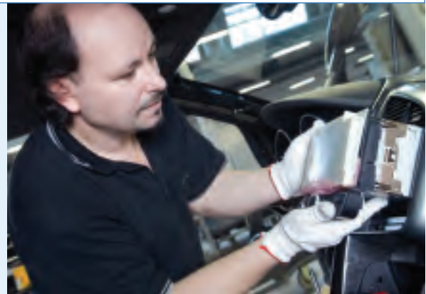
„SilverLiner“: Fernando Pereira beim Einbau eines Radiomoduls in die Mittelkonsole.
