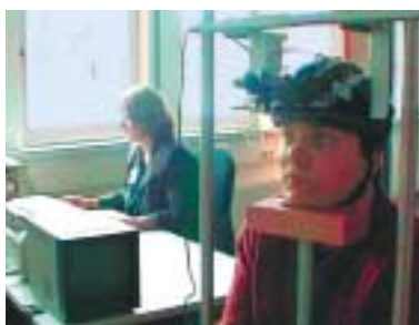
Der Blickverfolger einschließlich eines Gestells zur Minimierung von Kopfbewegungen
