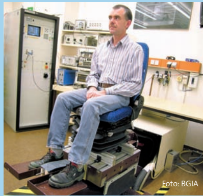
Schwingungstest eines Fahrersitzes.
