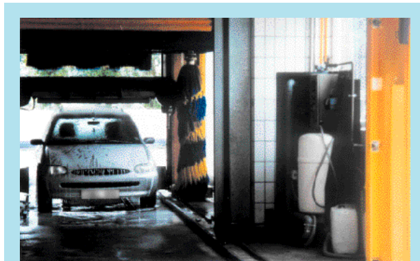
Wasseraufbereitungsanlagen bei der maschinellen Fahrzeugwäsche bringen oft nur eine geringfügige Reduzierung des Keimgehaltes
